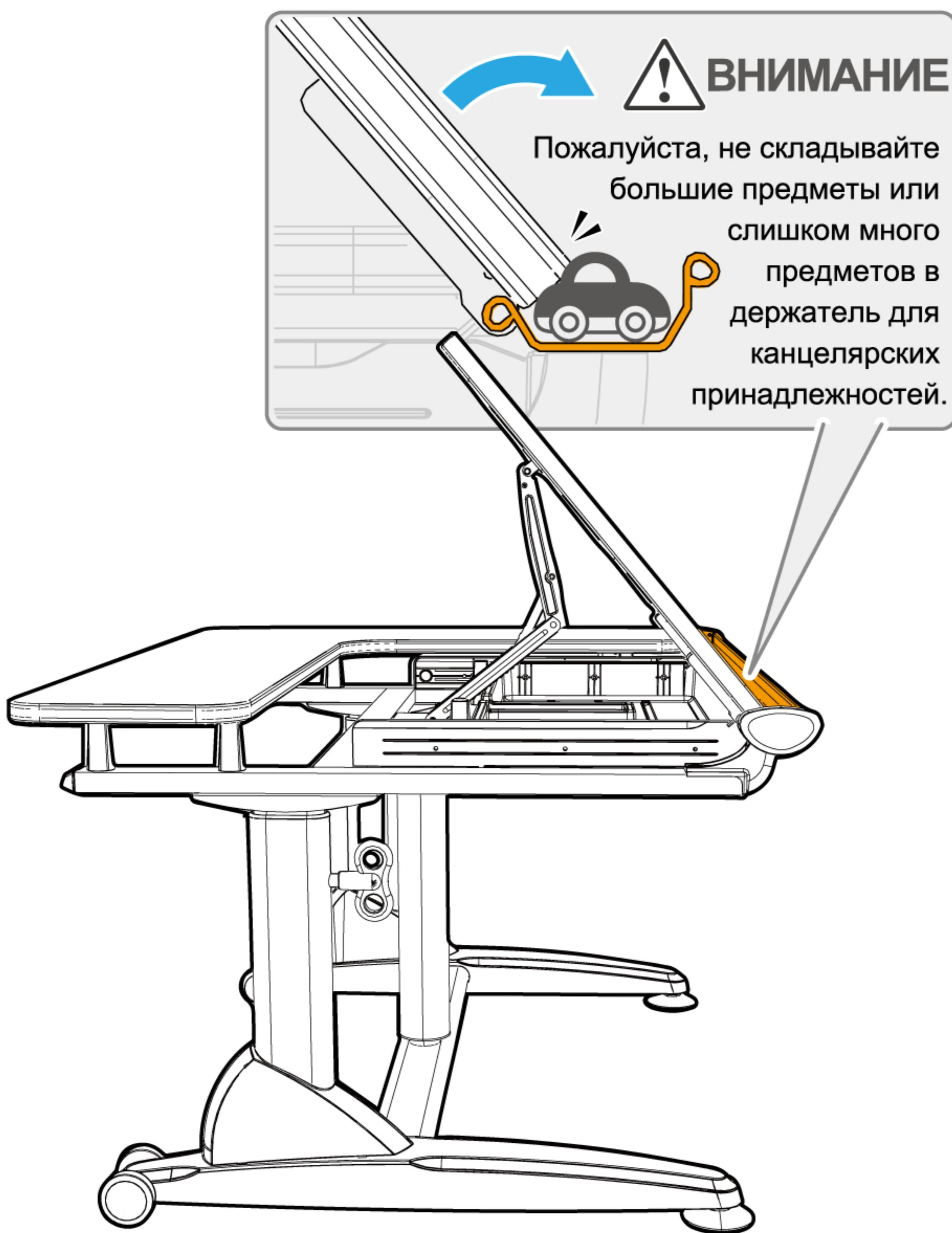
Чтобы вернуть столешницу в горизонтальное положение, поднимите столешницу до максимального верхнего положения и отпустите вниз; не давите, столешница плавно опустится.
