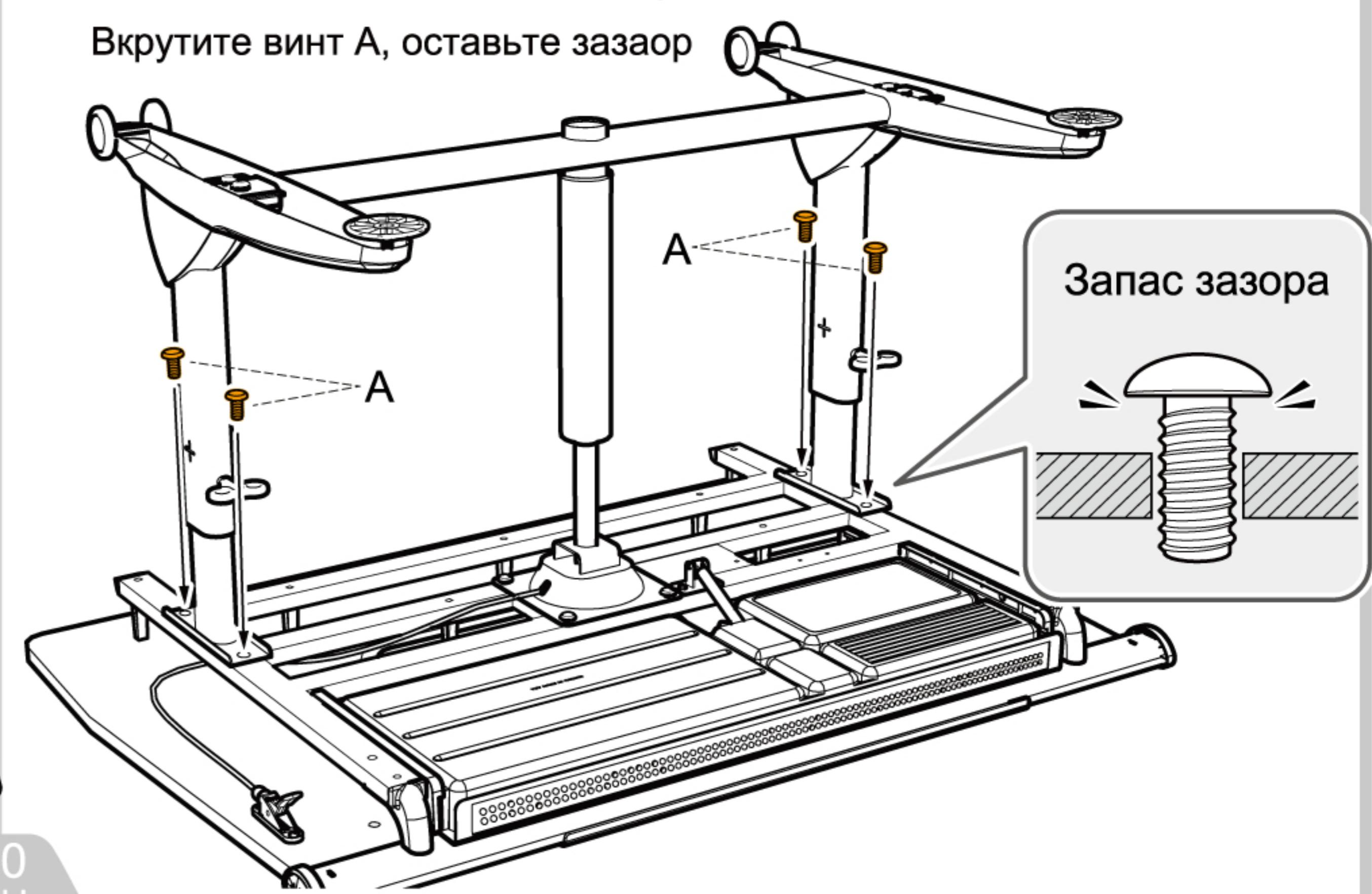
Вкрутите винт A, оставьте зазор
